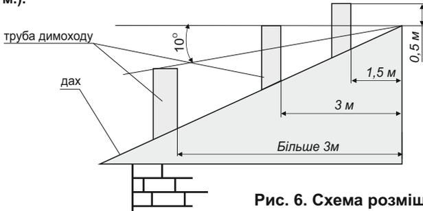
Рис. 6. Схема розміщення димоходу
