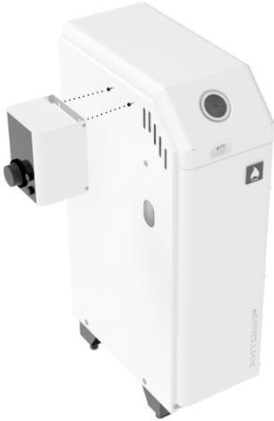
Для кріплення блока управління теном, передбачені два отвори на боковій стінці облицювання котла діаметром 3,2 мм.
