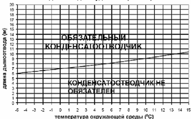
Раздельное дымоудаление (Ø80мм)
